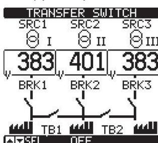
С помощью всего одного контроллера автоматического ввода резерва можно управлять системами, которые в прошлом требовали установки нескольких контроллеров с каскадным соединением. Предусмотрены 14 конфигураций системы.
