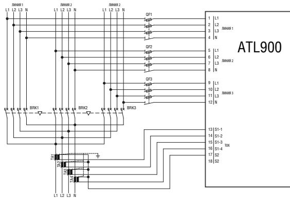
Схемы силовых соединений
