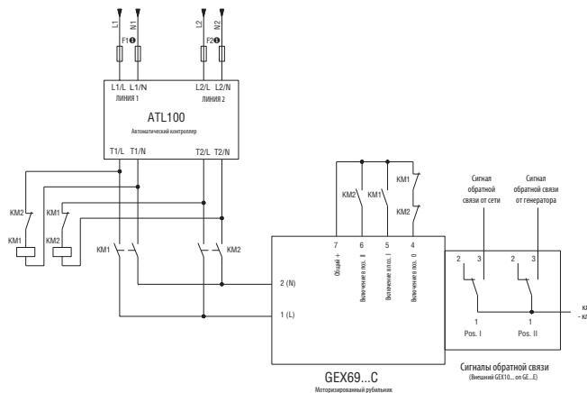
① предохранители, макс. размык. способность 4A
