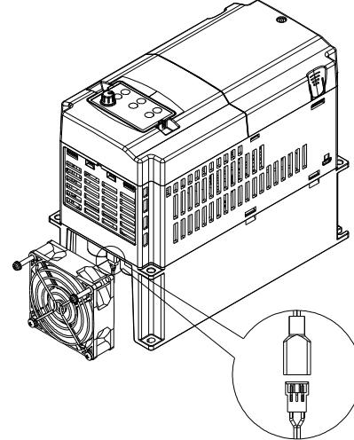
※ 1 VFD040CB43A-20/-21/-21M; VFD055CB43A-20/-21/-21M: optional fan model# 『MKCB-AFKM1』 .
