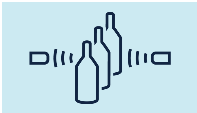
Принцип действия ультразвуковых сквозных барьеров
