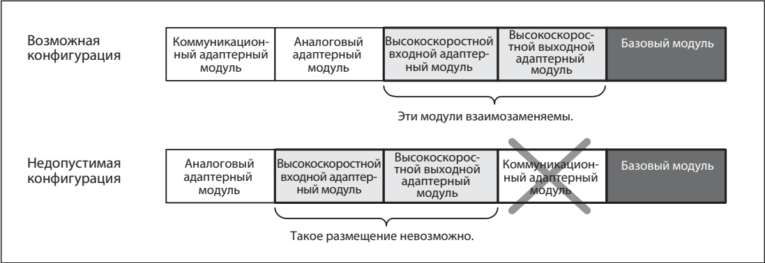
Рис. 2-12: Сначала следует подсоединить к базовому модулю высокоскоростные адаптерные модули ввода/вывода
