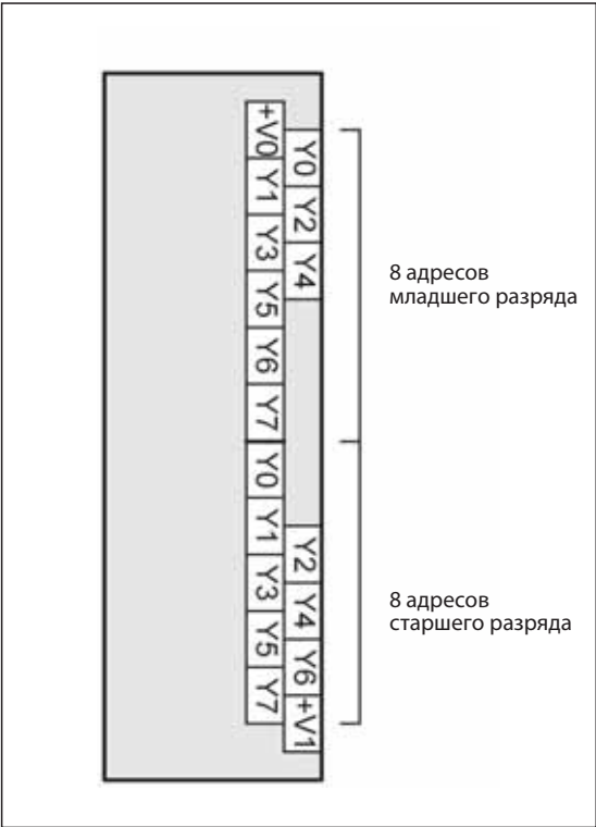
Рис. 14-12: Распределение клемм модуля расширения без блока питания FX2N-16EYT-ESS/UL с 16 транзисторными выходами
