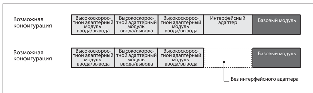
Рис. 2-9: Если подсоединяются только высокоскоростные адаптерные модули ввода/вывода, то от использования интерфейсного адаптера можно отказаться.
