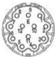
Ansicht Gerätestecker M23 am Gehäuse.
